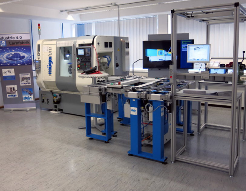
Die Lernfabrik in der Feintechnikschule im Schwarzwald fertigt vollautomatisch und individuell Schlüsselanhänger.
